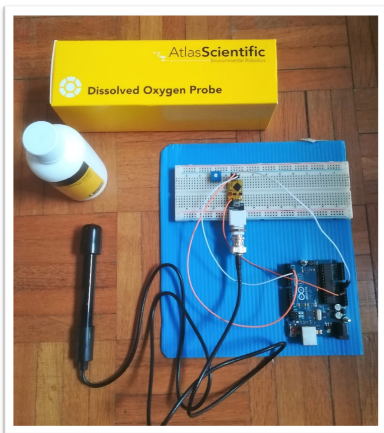
Figura 4 - Sonda per la misura dell'ossigeno disciolto collegata ad una scheda microcontrollore Arduino.
